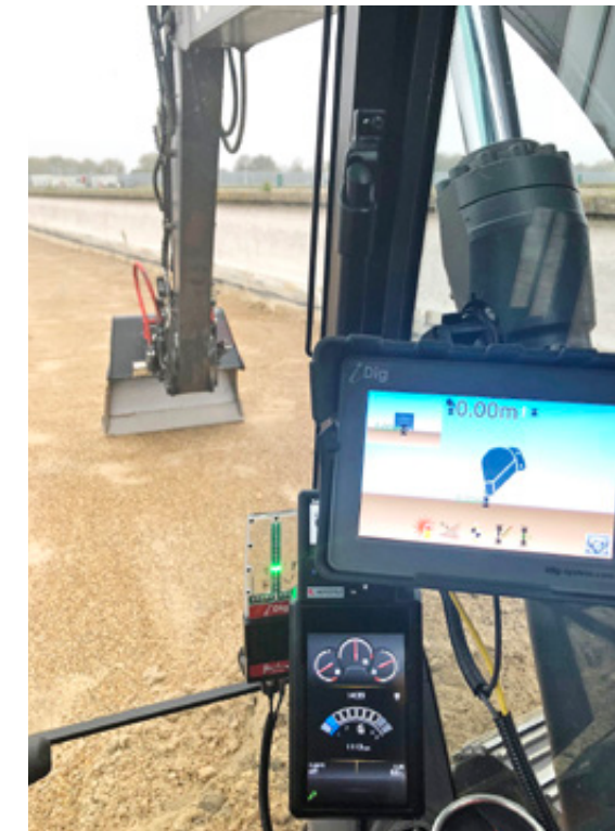
Das iDig-Baggersystem arbeitet mit kabellosen und solargeladenen Sensoren. Es kann in wenigen Minuten von Maschine zu Maschine umgebaut werden.
